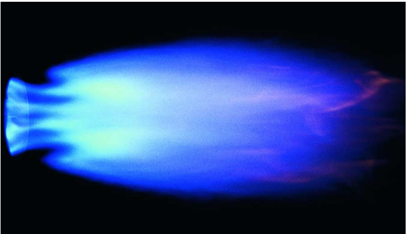
Typisches Flammenbild bei Gasbrennern in Ausführung LN (LowNO x )
