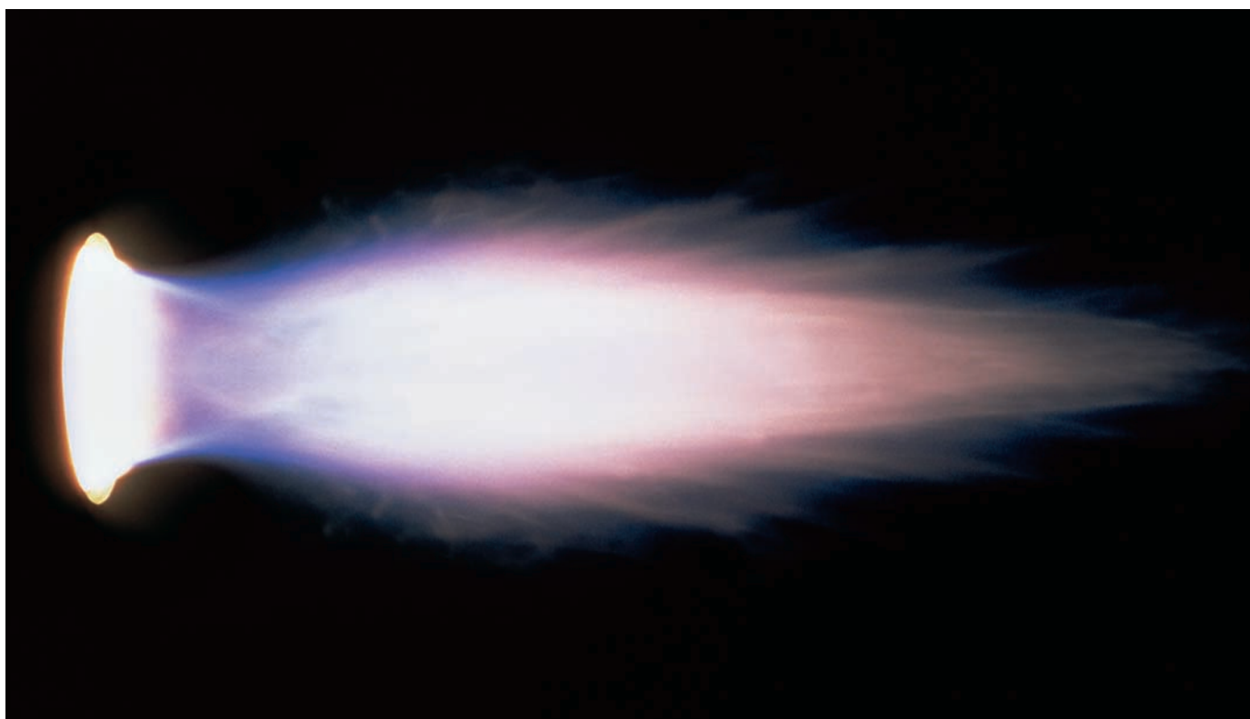
Forme typique de la flamme pour des brûleurs fioul de type LN (Low NO x )
